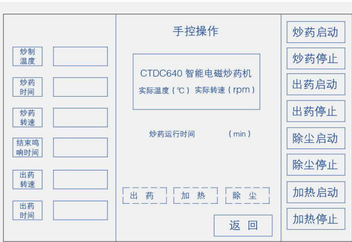
图1 智能电磁炒药机手控界面
