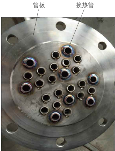
图2 换热管数量较少时施焊图
