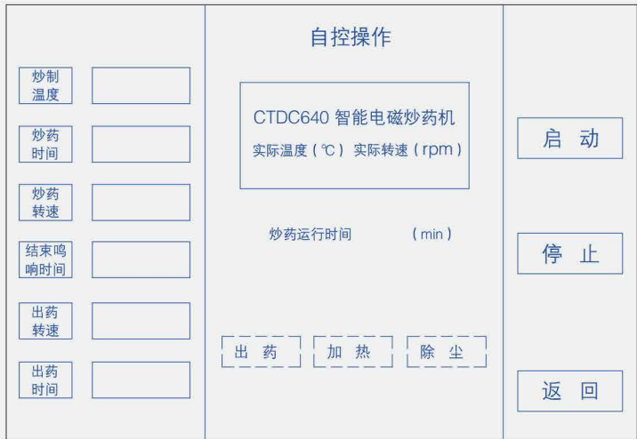
图2 智能电磁炒药机自控界面
