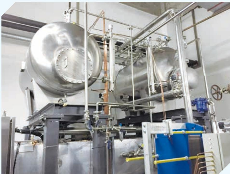
图2 过热水制备系统和储存装置
