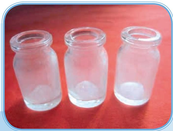
图7 冻干产品复溶后产生浊度
