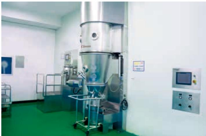
图2 穿墙布局的操作区
