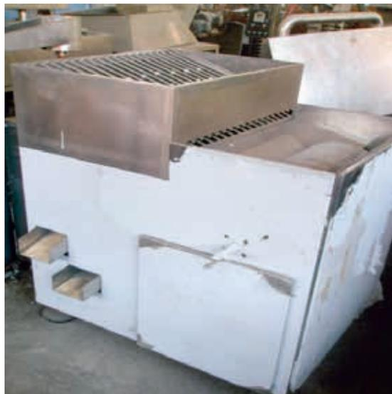
图7 塑壳内有无中药丸检测分离机样机
