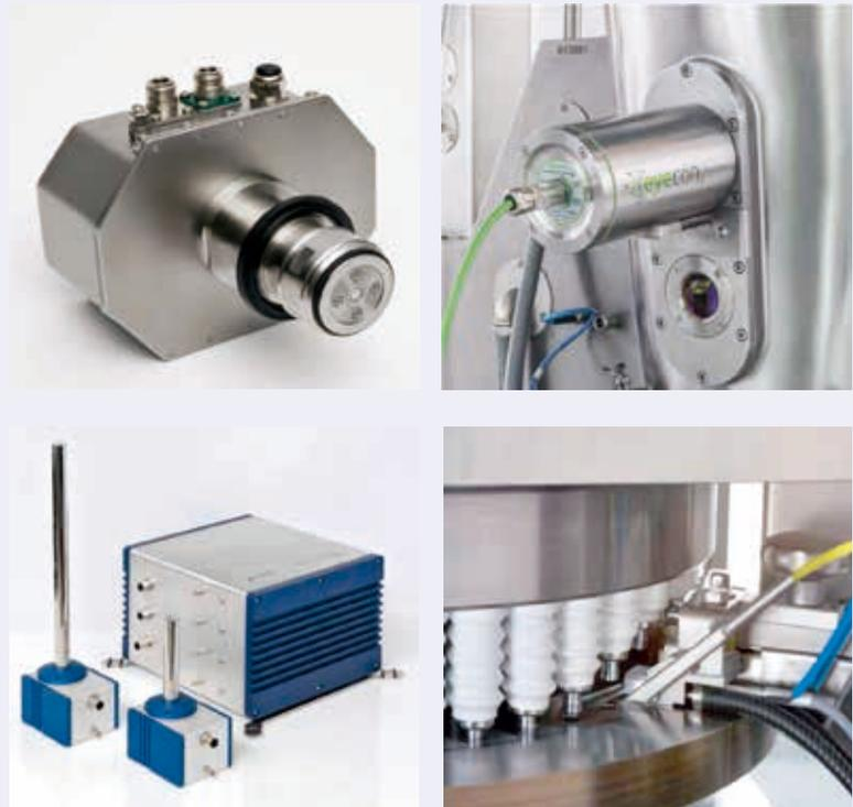
图9 卓越联盟的连续片剂生产线中使用的在线控制单元
