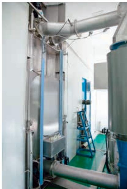
图3 穿墙布局的沸腾干燥机维修区
