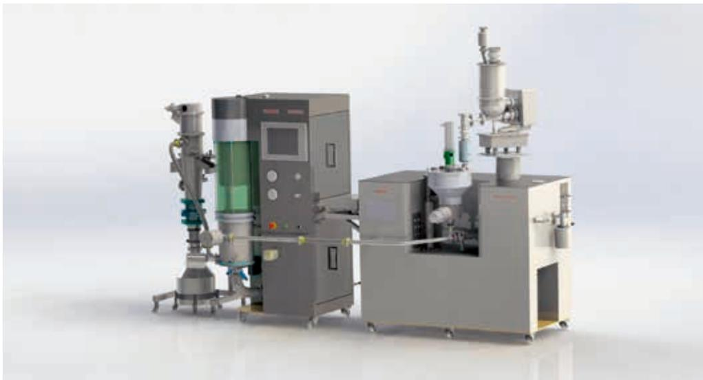
图11 博世Xelum R&D固体制剂连续生产系统
