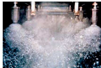
图3 运行中的喷雾型热压式蒸馏水机
