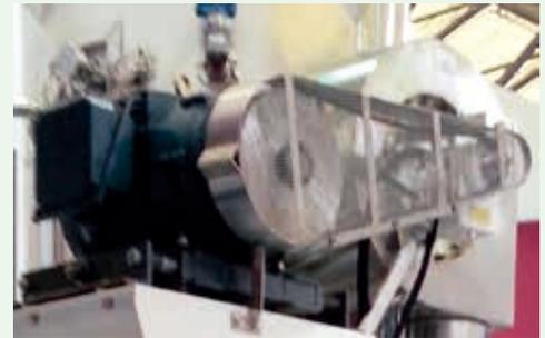
图4 皮带驱动型压缩机
