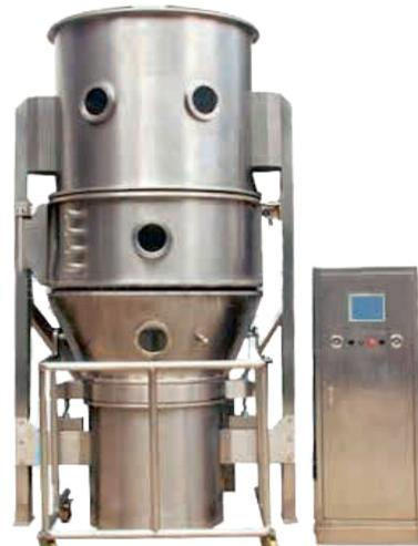
图19 沸腾制粒机（一步制粒机）
