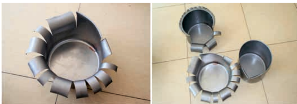
图5 低镍高锰200系不锈钢冲压成型后的开裂现象
