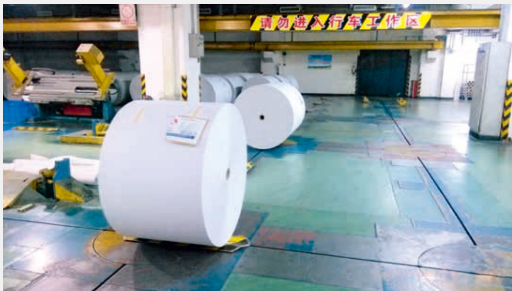
图9 隐式动力轨道输送线
