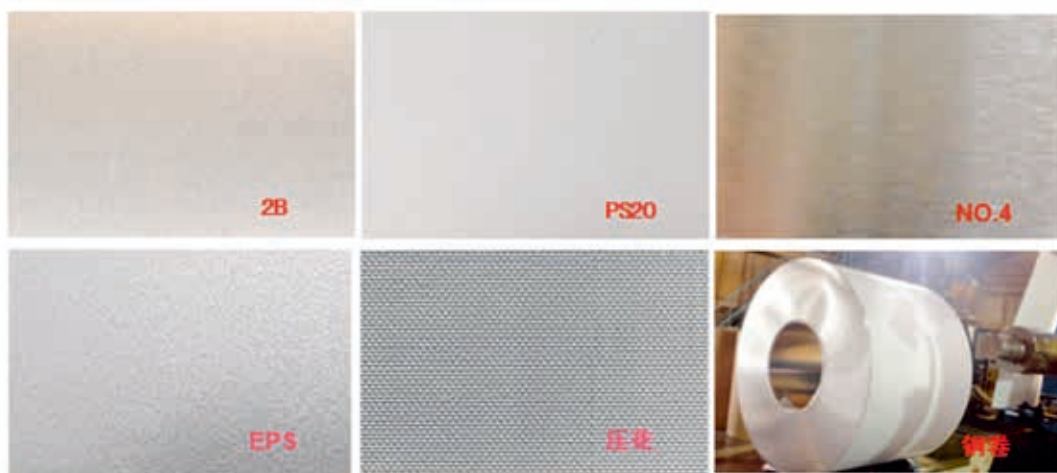
图12 不同表面处理后钢卷的表面形貌
