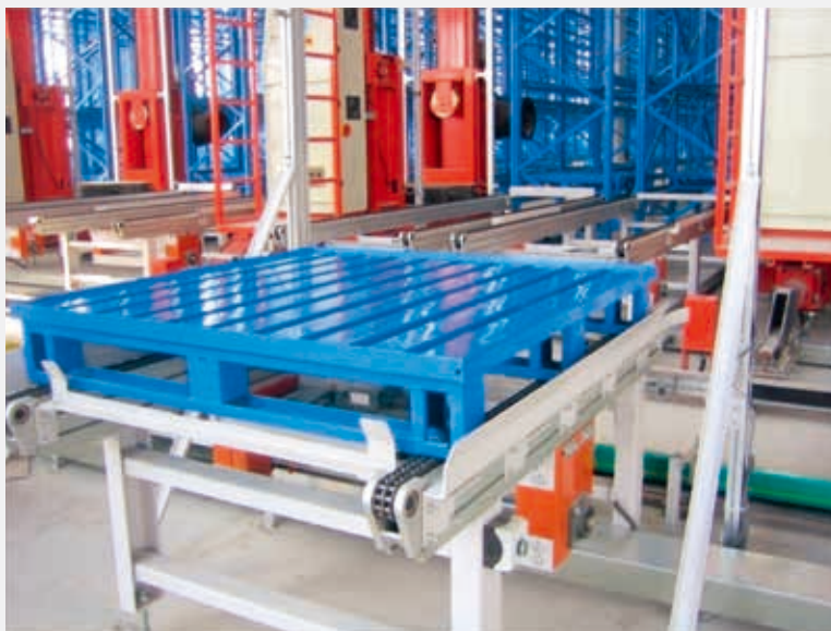
图6 链条输送机、辊子输送机
