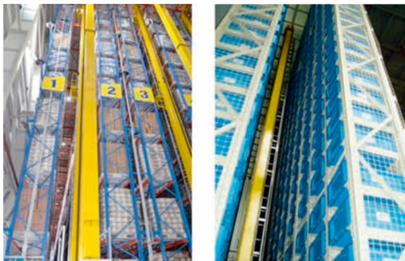
图2 单元货格式货架
