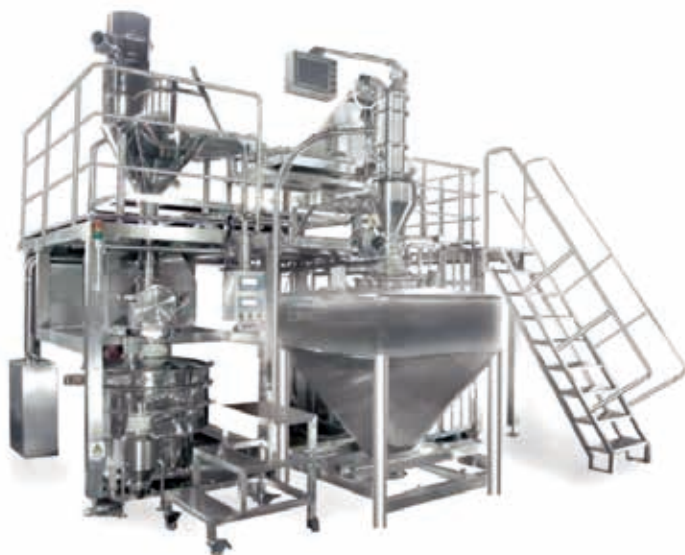
图3 集成式投料粉碎筛分系统
