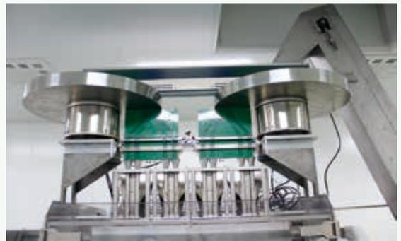
图5 以药粒累计直径高度数粒的多列袋式包装机
