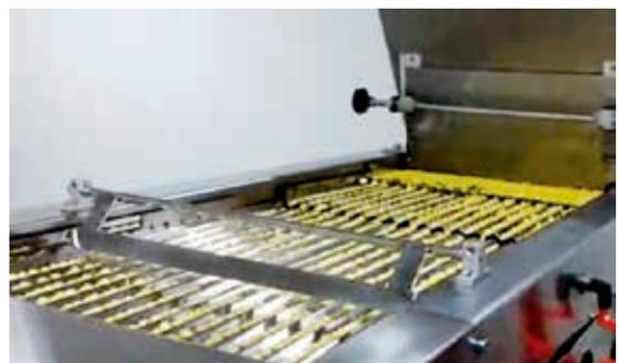
图2 振动式输送数粒机
