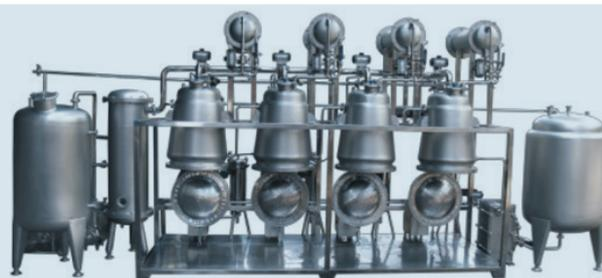
图3 连续逆流提取设备
